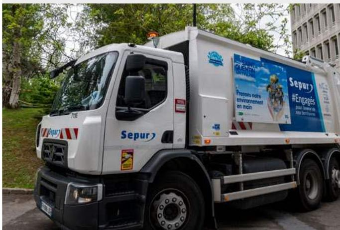
Depuis le 1<sup>er</sup> janvier 2021, la flotte de Bennes à Ordures Ménagères (BOM) roule au Gaz Naturel pour Véhicules (GNV). Ainsi, ces nouveaux véhicules diminuent l'empreinte environnementale : **une BOM roulant au GNV réduit de 15% les gaz à effet de serre** émis par rapport à un véhicule roulant au gazole. Cette motorisation permet aussi de garantir plus de confort pour les équipages et les riverains, puisqu'elle engendre une tournée moins bruyante qu'une motorisation classique.
