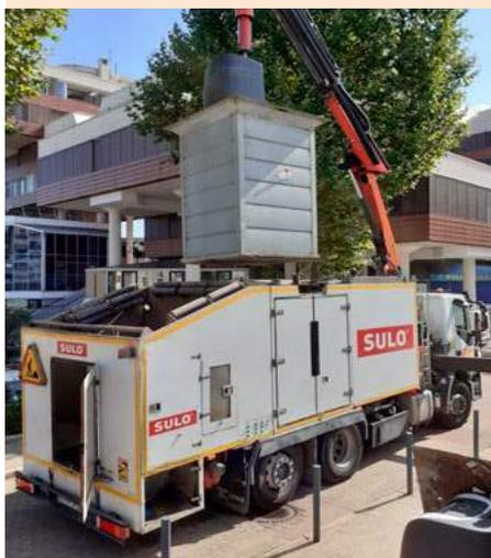
Les usagers disposent sur le territoire d'environ 320 bornes d'apport volontaire. Plus de la moitié sont enterrées ou semi-enterrées. Chaque année, toutes les bornes font l'objet d'un lavage complet, afin d'assainir et contrôler le matériel.
