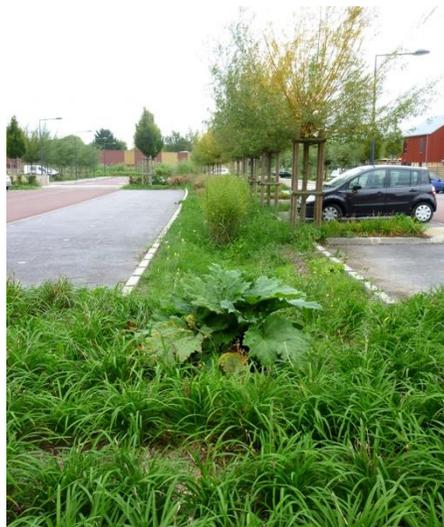
Exemples de gestion intégrée des eaux pluviales (noue) pour un parking.
